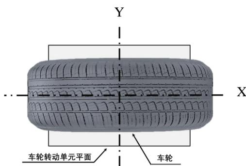
图3 车轮安装放置车轮转动单元平面示意
